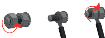
Figura 7. Conexión del equipo a una instalación equipotencial.
