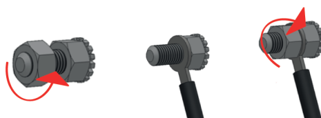
Bild 3. Der Anschluss des Gerätes an die Potentialausgleichsanlage
